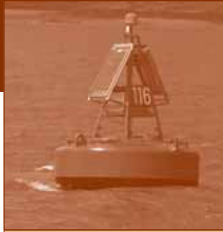
Zeeboei met PV-modules (Soltech)
