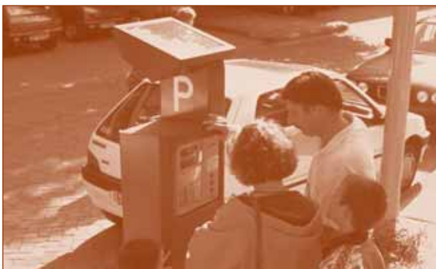
Parkeermeter met autonoom PV-systeem
