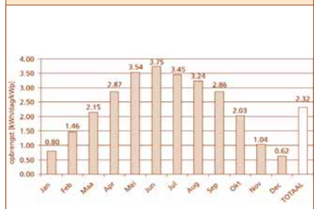
Gesimuleerde opbrengst van het 2,3 kWp PV-systeem te Malle per maand en per jaar (laatste balk)
